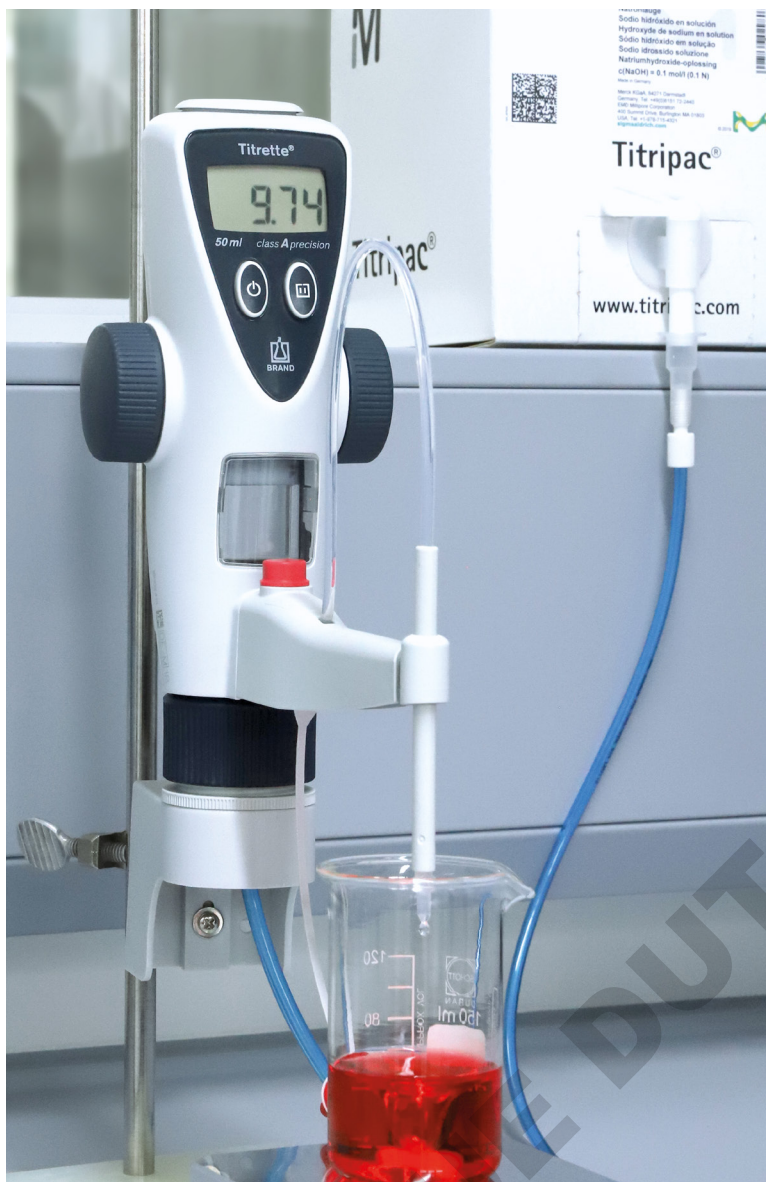
Système de prélèvement Titrette® pour système d'emballage Bag-in-Box (Titripac® est une marque déposée de Merck KGaA, Darmstadt, Allemagne)
