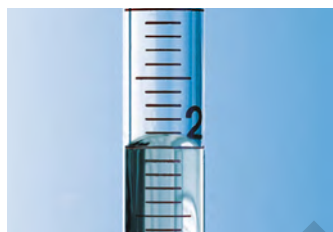
Ménisque convexe dans une pipette graduée.
