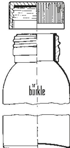
Le flacon aluminium est spécialement adapté au stockage, au transport ou à l'expédition de substances et d'échantillons qui doivent être conservés totalement intacts. Autres caractéristiques importantes : se vident jusqu'à la dernière goutte, inodores, opaques, inoxydables.
