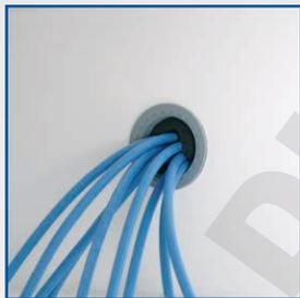
Passage de cuve diamètre 30 mm pour caractérisation et qualification sur site. Positionné sur la porte à 1/3 du haut (pour chaque compartiment).
