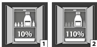
**Selon la norme EN 14470-1 :** Le bac de rétention au sol doit présenter une capacité minimale de 10 % de tous les contenants stockés dans l'armoire [1], ou minimum 110 % de la capacité du plus gros contenant pris individuellement [2], selon la capacité la plus grande.
