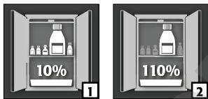
**Selon la norme EN 14470-1 :** Il faut toujours installer un bac de rétention au sol en dessous du niveau de pose inférieur ; le bac de rétention au sol doit présenter une capacité minimale de 10 % de tous les contenants stockés dans l'armoire **1**, ou minimum 110 % de la capacité du plus gros contenant pris individuellement **2**, selon la capacité la plus grande.
