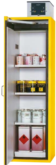
Armoire de sécurité S-CLASSIC-90 Modèle S90.196.060 Jaune sécurité (RAL 1004), porte à charnières gauche avec 3 étagères, cailllebotis et bac de rétention au sol (en acier revêtement époxy), caisson de ventilation avec filtration intégrée en option Code article 30227-002-30249
