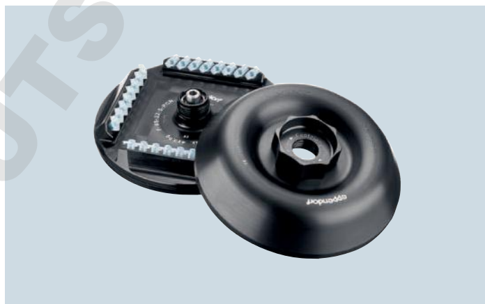
Rotor pour 4 barrettes PCR, vitesse max. 18 615 × g/15 000 tr/min (F-45-32-5-PCR ; code 5424 704.000).
