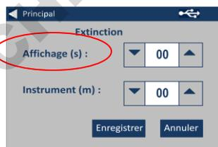
5b - Réglez à l'aide des flèches haut et bas le délai avant extinction de l'instrument en cas d'inactivité.
