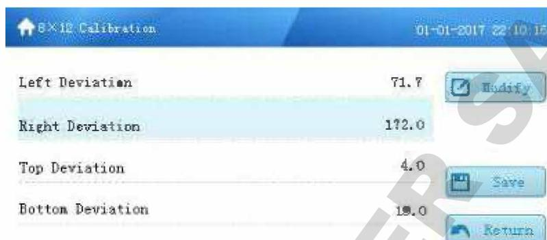
**Left deviation:** Left deviation signifie la distance entre l'aiguille et le centre gauche de la microplaque.
