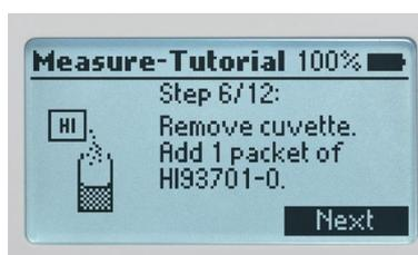
Mode tutoriel guidant l'opérateur pas à pas au cours d'une mesure ou d'un étalonnage
