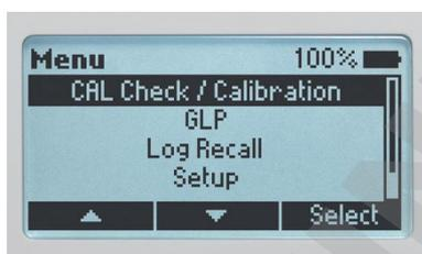
Des fonctions avancées : CAL Check pour contrôler la performance de l'instrument, BPL mémorisant les données d'étalonnage
