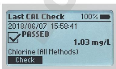
Écran matriciel rétro-éclairé permettant fluidité opérationnelle
