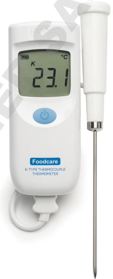
Sonde de température interchangeable à thermocouple type K
