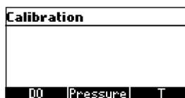
Appuyez sur la touche fonctionnelle **Pressure** pour sélectionner l'étalonnage de la pression. L'écran de l'étalonnage de la pression sera affiché.
