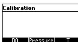
Appuyez sur la touche fonctionnelle **T** pour sélectionner l'étalonnage de la température.
