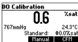
Appuyez sur **CFM** pour confirmer le point d'étalonnage.
