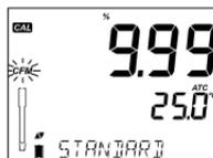
Appuyez sur CAL pour quitter l'étalonnage après l'étalonnage de la pente. L'instrument affiche le message "SAVING" et retourne en mode mesure tout en enregistrant la pente dans les données d'étalonnage.
