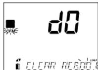
L'instrument affiche "CLEAR REC." et le numéro de l'enregistrement avec "CFM" clignotant. Utilisez les flèches pour sélectionner un autre enregistrement si nécessaire.
