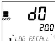
Lorsque le paramètre clignote et le message "LOG RECALL" est affiché, appuyez sur CLR. Le message "CLEAR ALL" et le paramètre s'affichent et le symbole CFM clignote. Appuyez sur CFM.
