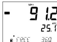
Un nouvel appui sur la touche LOG arrêtera l'enregistrement. Le message "LOG STOPPED" s'affichera pendant quelques secondes.
