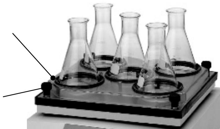
entoure le tube. Vissez le tube dans les coins à la table à secousses à l'aide des 4 vis moletées. Les fioles coniques doivent être installées une par une dans leur logement. Pour faciliter leur installation et leur retrait, inclinez-les légèrement. Le
