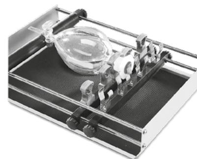
Les tringles support et les tringles à ressort sont spécialement pour la fixation des ampoules de décantation. On fixe les goulots avec les pinces gris, les bouchons sont pressés sur les ampoules par le tringle à ressort. Le bout est appuyé sur le tringle de serrage h. Pour la modification de la plateforme standard ou en complément des tringles de serrage existants.
