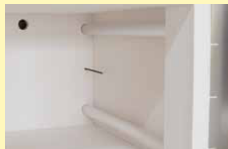
Eléments chauffants protégés dans des tubes en verre quartz
