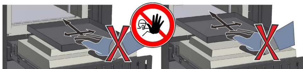
Fig. 36 : Exemple : Éviter d'endommager l'isolation de la porte (figure similaire)
