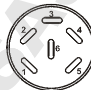
Figure 29: Affectation des pins de la douille DIN (3) au dos de l'appareil
