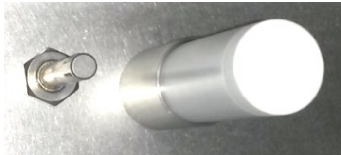
Figure 10: Détecteur de CO 2 (à droite) branché et tête de mélange de gaz CO 2
