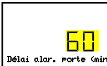
Réglage du délai d'alarme de porte ouverte.
