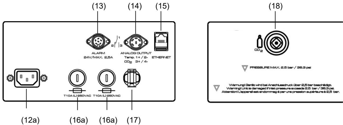
Figure 7: Tableau d'instruments CB-S au dos de l'appareil avec des options
