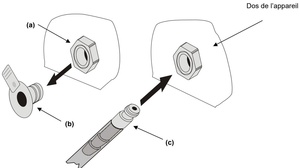
Figure 12: Montage de la connexion des tubes des bouteilles de gaz
