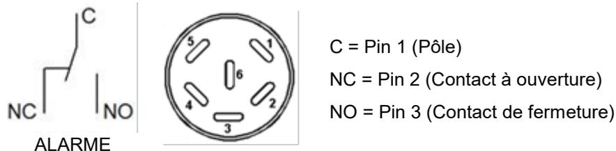
Figure 15: Schéma du contact sans potentiel et l'affectation des pins de la douille DIN (13)
