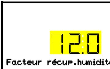
Réglage de la puissance de chauffage en vue de la récupération du taux d'humidité.
