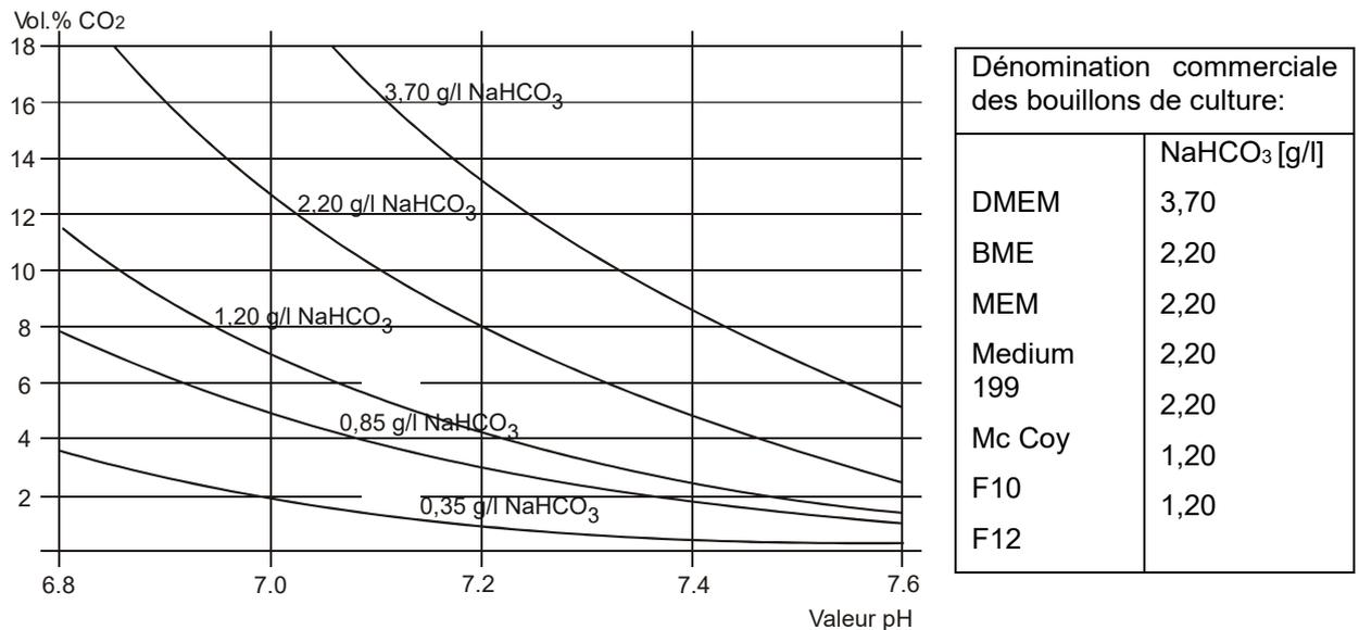
Figure 16: Valeur pH des bouillons courants de culture, tamponnés par NaHCO<sub>3</sub> en fonction de la concentration de CO<sub>2</sub>
