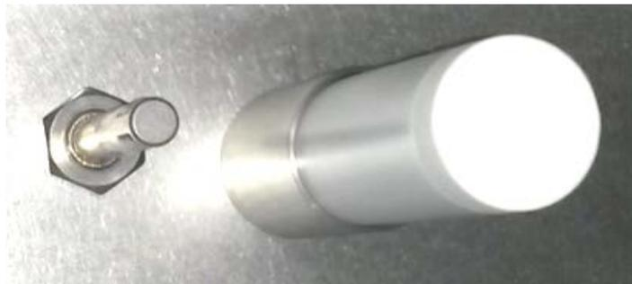
Figure 10: Détecteur de CO<sub>2</sub> (à droite) branché et tête de mélange de gaz CO<sub>2</sub>
