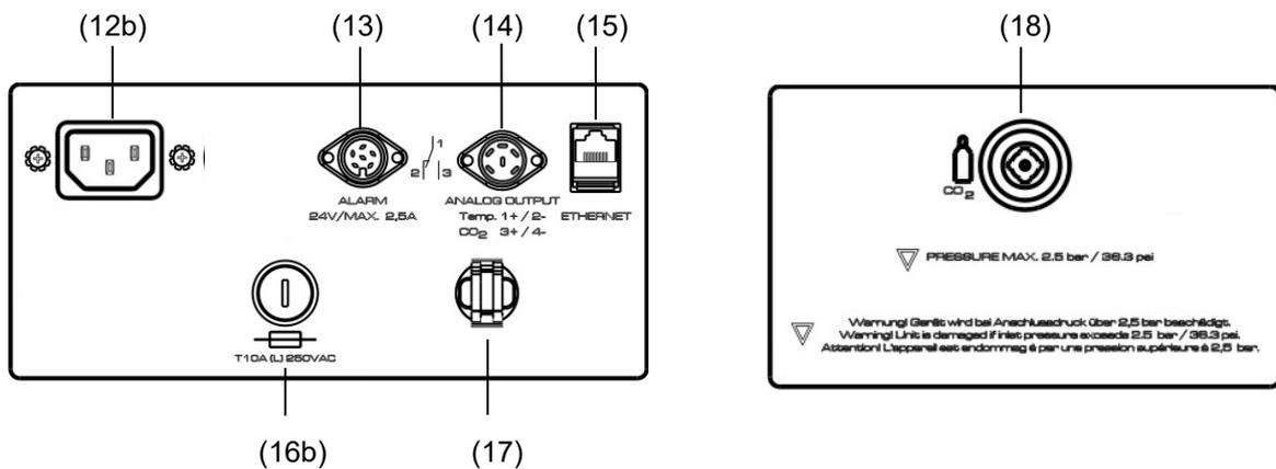
Figure 8: Tableau d'instruments CB-S-UL au dos de l'appareil avec des options
