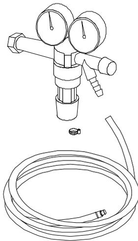
Avec le kit de connexion pour CO<sub>2</sub> (réf. 8012-0014), les parts suivants pour la connexion d'une bouteille de gaz à l'incubateur sont fournis.
