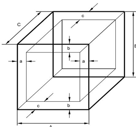
A, B, C = dimensions intérieures (largeur, hauteur, profondeur)
