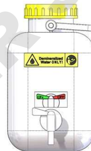
Figure 10: Nourrice d'eau fraîche avec le robinet de sortie ouvert
