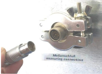
Figure 27: Connexion de mesure (12) avec passage de mesure
