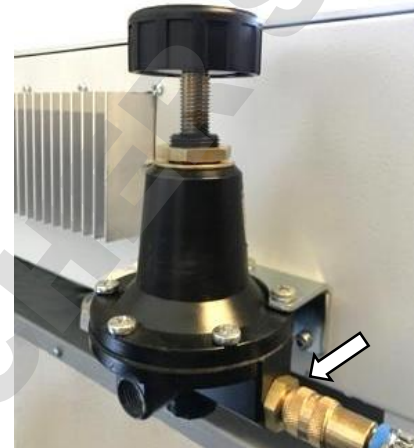
Figure 12: Raccordement d'air comprimé au régulateur de pression
