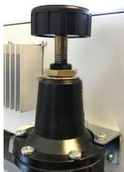
Figure 22: régulateur de pression pour le balayage avec de l'air comprimé à l'arrière de l'appareil, en haut à droite
