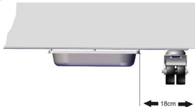
Figure 17: Le positionnement du bac collecteur de condensé (vue de l'avant)
