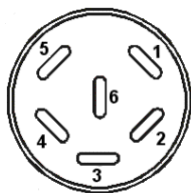
Abb. 26: Pinbelegung der DIN-Buchse (10) für Option Analogausgang
