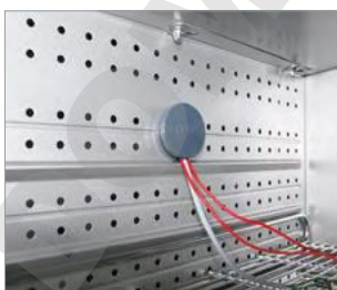
Port d'accès équipé d'un obturateur en silicone
