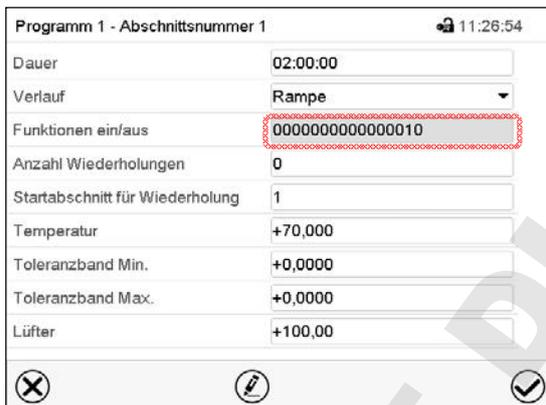
Abschnittsansicht mit Anzeige der Steuerkontakte
