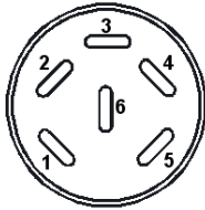
Figure 21: Affectation des pins de la douille DIN (6)
