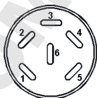
Figure 20: Occupation des pins de la douille de raccordement (3) pour l'option Sorties analogiques
