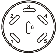
Figure 13: Affectation des pins de la douille DIN (6)
