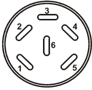
Figure 13: Affectation des pins de la douille DIN (6)
