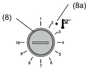
En tournant le bouton (8) au maximum (position 10), la sécurité de haute température classe 3.1 sert à protéger l'appareil. Si la sécurité de haute température est réglée sur une température un peu plus élevée que celle de consigne choisie sur le régulateur, elle protège le chargement.
