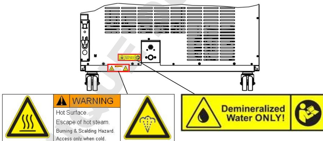
Figure 2: Position des signes au dos de l'appareil
