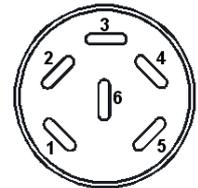
Figure 21: Affectation des pins de la douille DIN (6)
