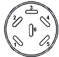
Figure 21: Affectation des pins de la douille DIN (6)
