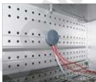
Port d'accès équipé d'un obturateur en silicone
