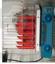
Puerto de acceso con tapón de silicona. Funcionamiento con agitador en la cámara
