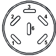
Figure 11: Occupation des pins de la douille de raccordement pour l'option Sortie analogique
