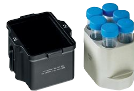
Nacelle 5628 avec adaptateur 6338-B
