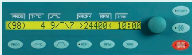
Panneau de commande des modèles ROTANTA 460 R, 460 RC et 460 RF (panneau de commande C)
