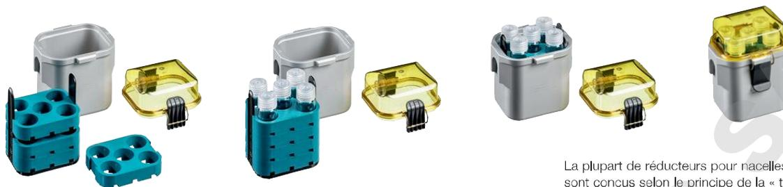
La plupart de réducteurs pour nacelles 5625-A et 4880 sont conçus selon le principe de la « technique du sandwich ». 1 à 2 plaques sont retirées pour les tubes les plus courts. Dans les tableaux, les plaques nécessaires sont indiquées en gris.
