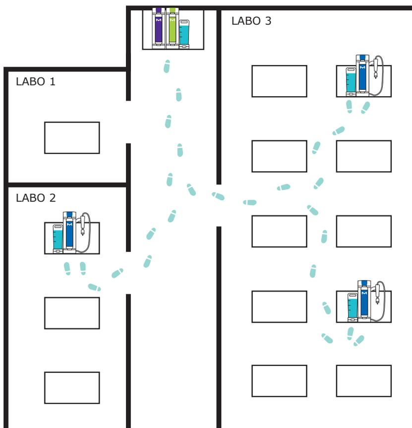
La configuration ci-dessus comprend 1 × station de production Milli-Q® SR 240L ; 1 × module de préfiltration Milli-Q® SP 240 ; 3 × modules de distribution Milli-Q® SQ 200 et 4 × cuves Milli-Q® SQ Switch.
