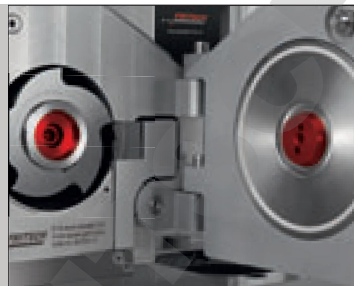
Rotor monté sur double palier conique sur l'arbre et dans le couvercle
