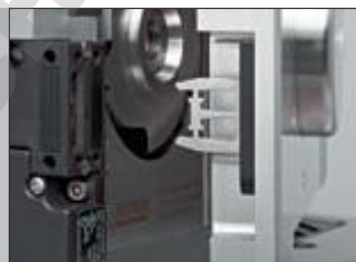
La fermeture en toute sécurité : le verrouillage de sécurité de la chambre de broyage
