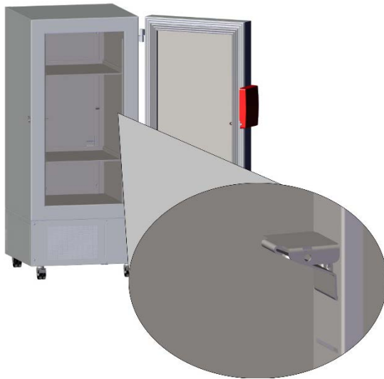
Figure 20: Insérer les supports de clayette
