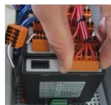
Fig. 12: Montage des modules de régulateur (figure similaire)
