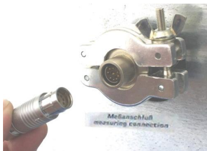
Figure 27: Connexion de mesure (12) avec passage de mesure
