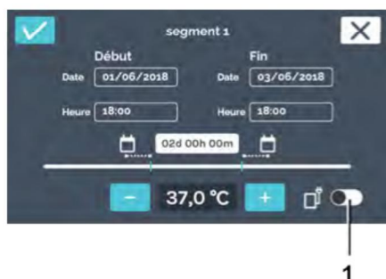
Fig. 110 : Activer le contrôle de contact électrique
