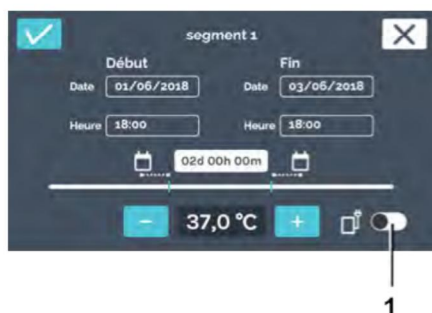
Fig. 110 : Activer le contrôle de contact électrique
