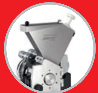
Trémie d'alimentation étanche en acier inoxydable, avec sas et coulisseau
