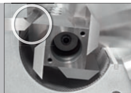
Rotor de coupe puissant PULVERISETTE 15 avec 4 couteaux droits
