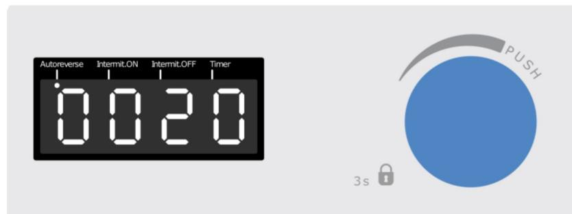
在每个设定的间隔时间后，旋转方向会发生变化。
