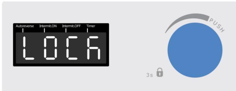
Si la función de bloqueo está activada, no es posible cambiar las condiciones de trabajo. En la pantalla aparece Lock si se pulsa o gira el botón.
