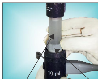
Copertura del serbatoio
