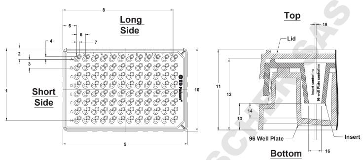
Falcon® 96-Multiwell Insert System: Plate Indexing
